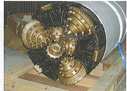
今回のローラーカッター・D型先導管
