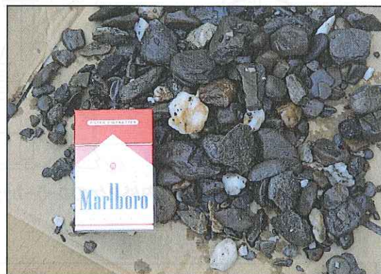
破碎された玉石 (発進坑で採取) (大きな碎石のまま排出されています)
