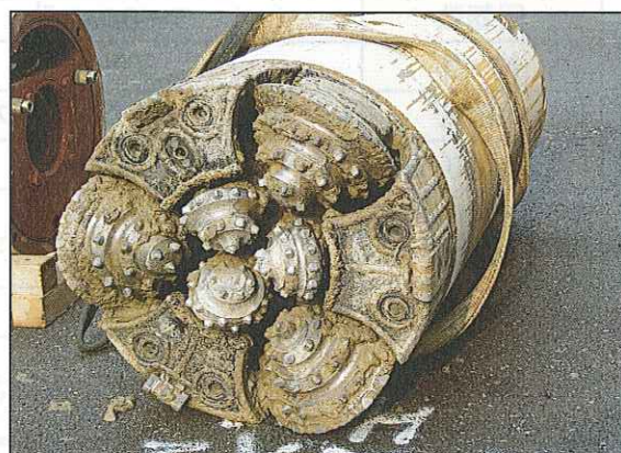
2nd Span 終了後のローラーカッター
