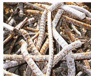
切削排出された鉄筋
